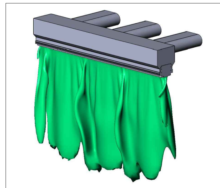
Изоповерхность скорости 0,6 м/с AESTHETIC+BOX-STD
